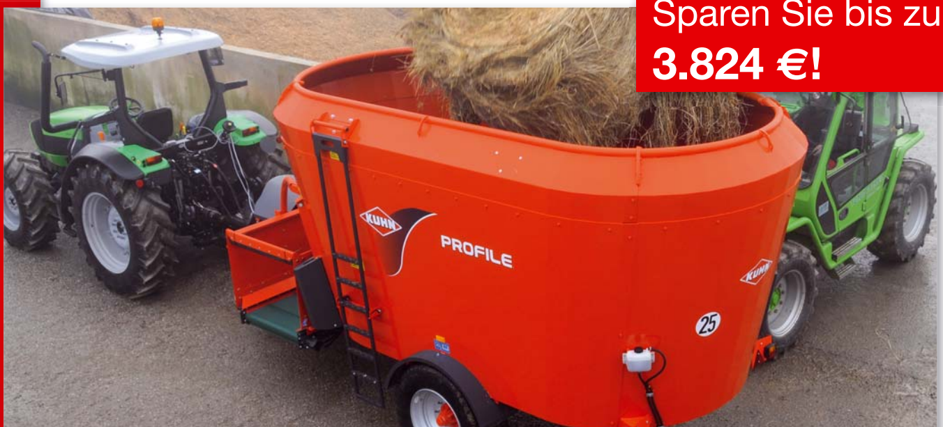
KUHN -Futtermischwagen EUROMIX und PROFILE mit zwei vertikalen Mischschnecken
